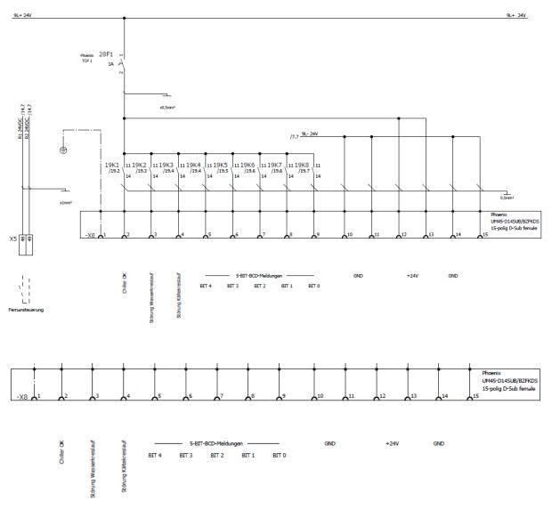
**X8.12** und **X8.13** wird von 9L- 24V auf L+ 24V geändert! **X8.12** and **X8.13** is changed from 9L- 24V to L+ 24V!
